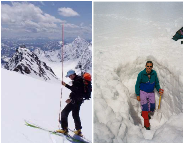
Figura 9. Ghiacciaio di Malavalle – sondaggi e trincea invernale (a sinistra), campagna topografica GPS ed approfondimento paline ablatimetriche (a destra).
