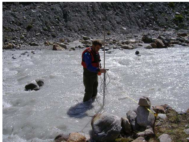
Abbildungen 12/13. Hydrologische Station am Bodenbach nahe der Grohmannhütte (links) und Abflussmessung mit Messflügel etwas bergaufwärts davon.
