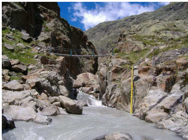
Figure 12/13. Stazione idrometrica sul rio Piana presso il rifugio Vedretta Piana (a sinistra) e misura di portata con mulinello idrometrico a monte della stessa (a destra).
