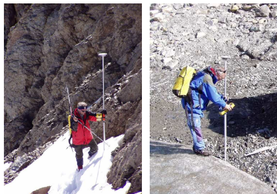
Abbildungen 8/9. Die frisch in Betrieb genommenen orographisch linke (links) und rechte Abflussmessstelle. Bestimmung des Gletscherrandes mit GPS (rechts).
