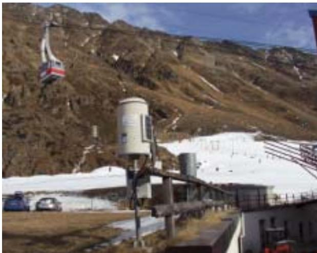
**Rechtes Bild:** Niederschlagsmesser und Temperatursensor der Messstation Kurzras im Schnalstal.
