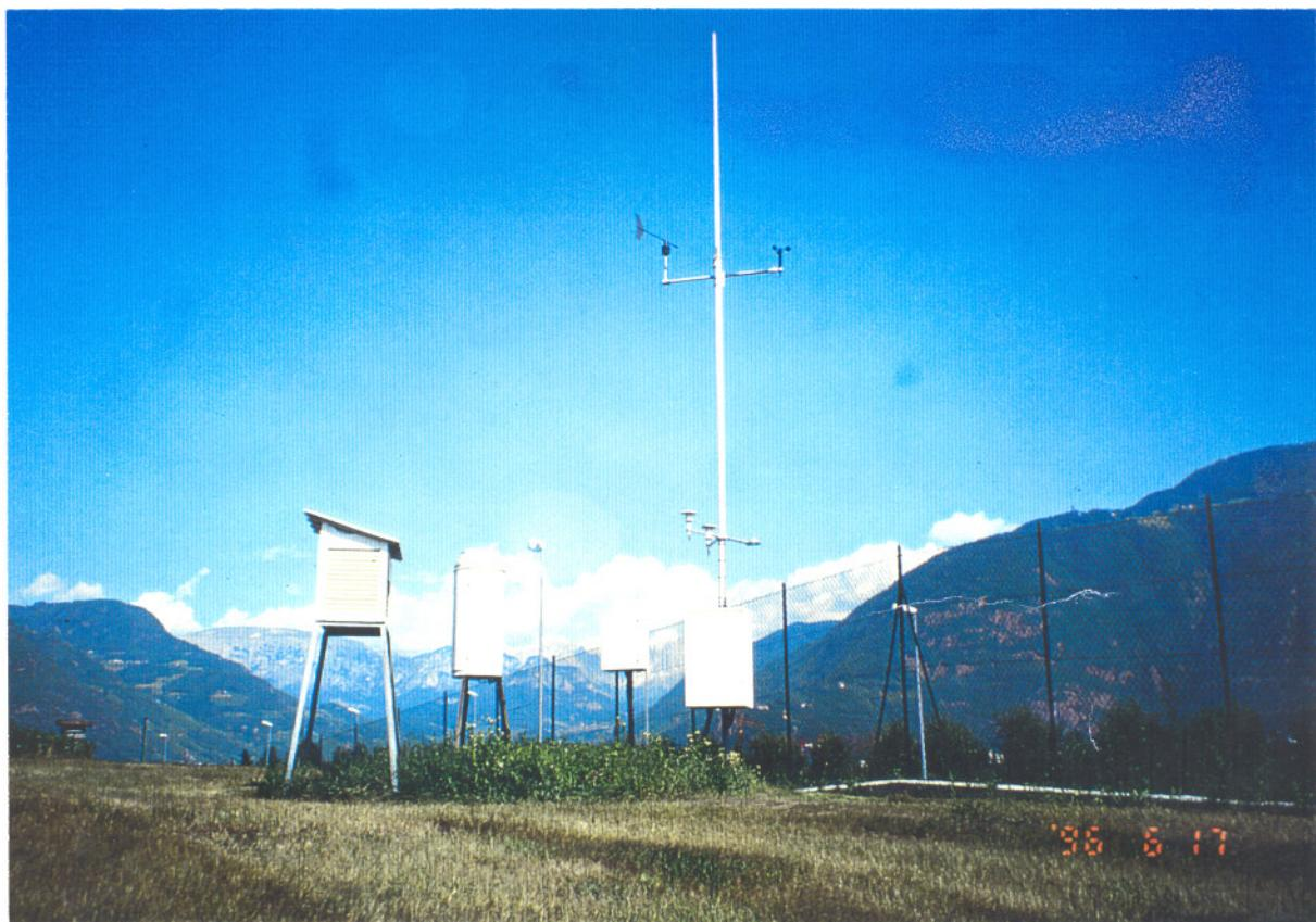
La foto mostra la stazione meteorologica automatica di Bolzano. Si notano da sinistra a destra: la capannina meteorologica, il sensore di precipitazione (bidone bianco) e sul palo di trasmissione i sensori per il vento, temperatura e radiazione solare. In Alto Adige, l'Ufficio Idrografico dispone di 36 stazioni automatiche in teletrasmissione, i cui dati vengono trasmessi ogni mezz'ora alla centrale e visualizzati in tempo reale su computer.
